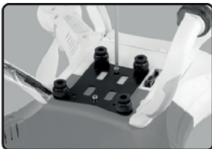
Fixez l'amortisseur de vibrations sous le drone.
