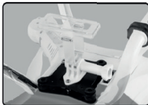
Installez le support de caméra.
